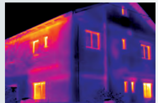
Vyhledání energetických ztrát budov: okamžité rozpoznání a zobrazení tepelných mostů na fasádách nebo v budově.
