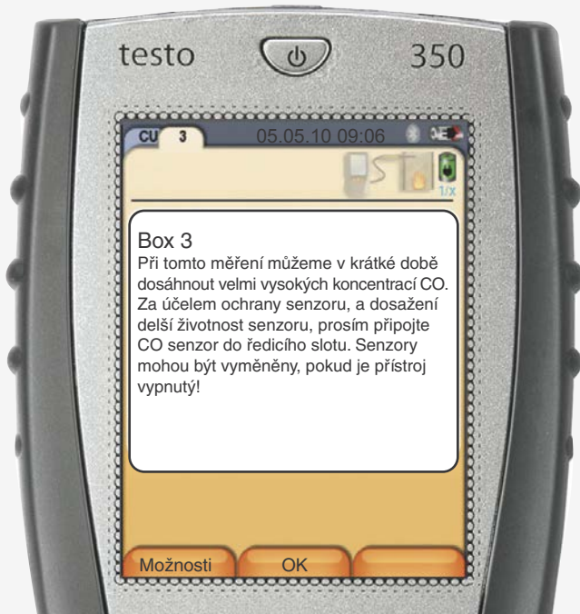
Příklad zobrazení na displeji řídicí jednotky funkce diagnostiky a pokyny ve stručné informaci
