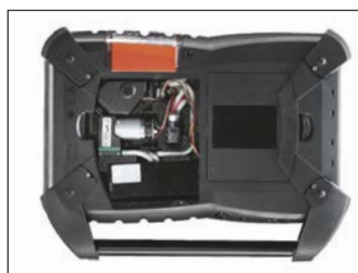
Servisní otvor se snadným přístupem k opotřebovaným dílům
