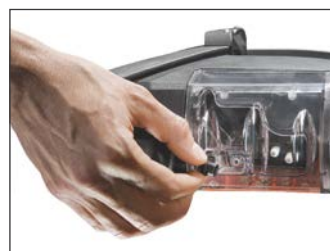
Kontinuální odtok kondenzátu při dlouhodobých měřeních
