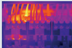
Údržba zařízení: rozpoznání příliš vysokých teplot na pojistkách a elektrických součástkách dřeva, než dojde k výpadkům.
