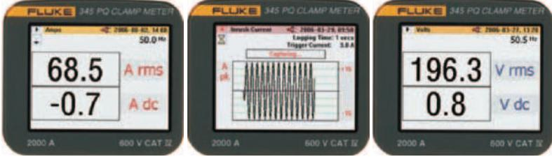
Model Fluke 345 měří širokou škálu parametrů el. energie nezbytných pro vyhledávání energetických poruch v jedno a třífázových systémech. Přístroj je velmi vhodný pro měření v systémech, kde jsou např. pohony s variabilní rychlosí, elektronická osvětlení, nebo zálohovací zdroje UPS. Paměť umožňuje dlouhodobý záznam pro analýzu trendů nebo občasně se vyskytující se problémy. Zobrazení grafů a tvorba zpráv se může provádět na PC pomocí softwaru Power Log, který je součástí dodávky.
