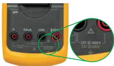
Používejte přístroje s těmito značkami: 1000 V CAT III nebo 600 V CAT IV
