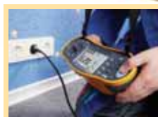
Testování elektrické instalace
