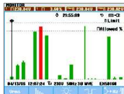
Přehled Systémového monitoru vám nabídne okamžitý pohled na to, zda napětí, harmonické, mihotání (flicker), frekvence a počet poklesů a překmitů přesahují nastavené limity. Získáte podrobný seznam všech událostí přesahujících nastavené limity
